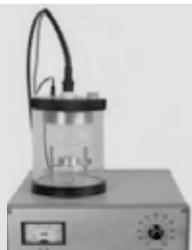
Установка магнетронного напыления (металлические мишени)
